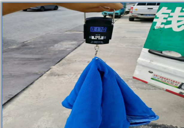
安全网进场验收
